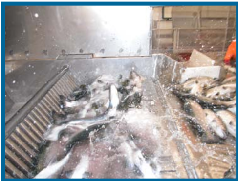
Bildet er fra Møvik slakteri, 2001, og viser laks som er bedøvet med CO 2
